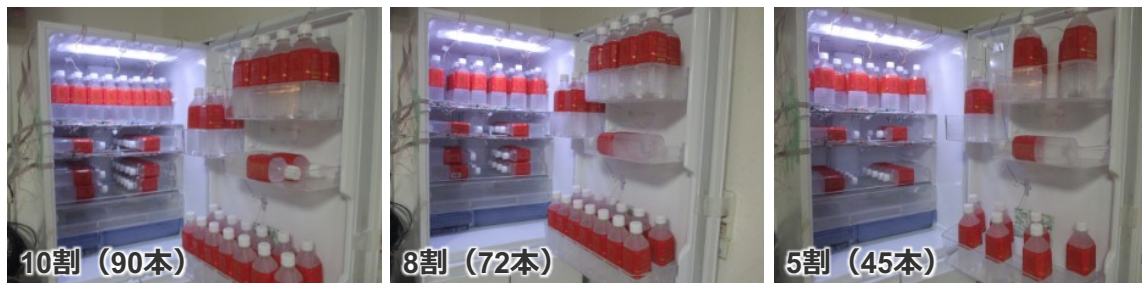
図 3. 冷蔵庫に冷却負荷を投入した様子
